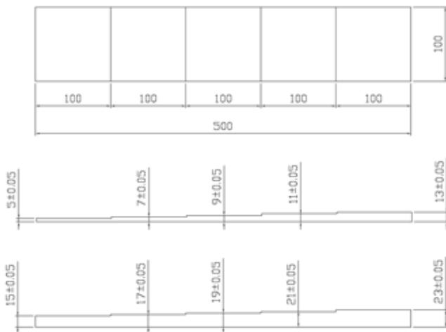
Fig. 9 板厚測定試験用試験体
