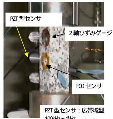
写真-3 一軸圧縮試験（花崗岩）
